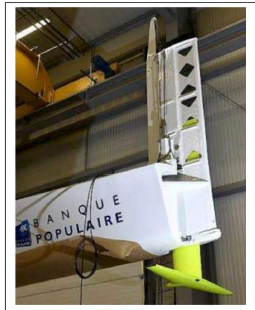
*Ci-dessus : plan porteur escamotable verticalement sur un safran et fletner sur le bord de fuite pilotant la rotation du safran.*
