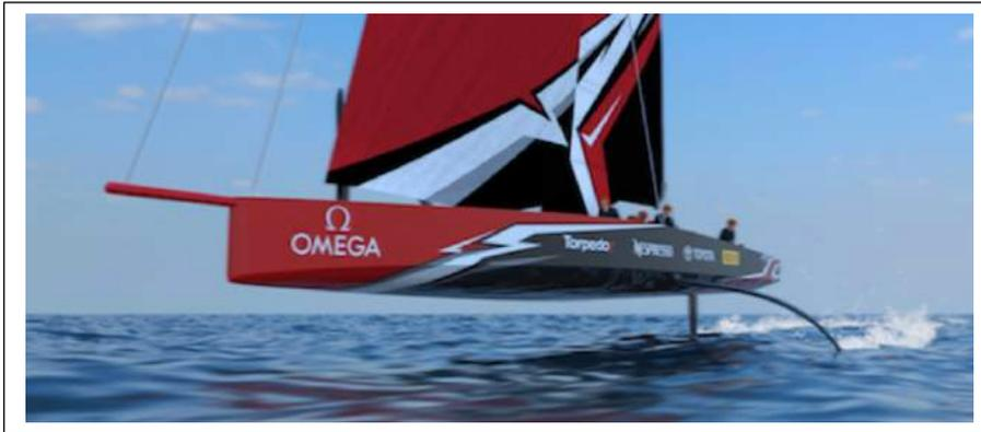
**La régulation contrôlée** de l'altitude de vol devient indispensable dès que l'on utilise des plans porteurs horizontaux. Le Foiler se « pilote » alors comme un avion.
