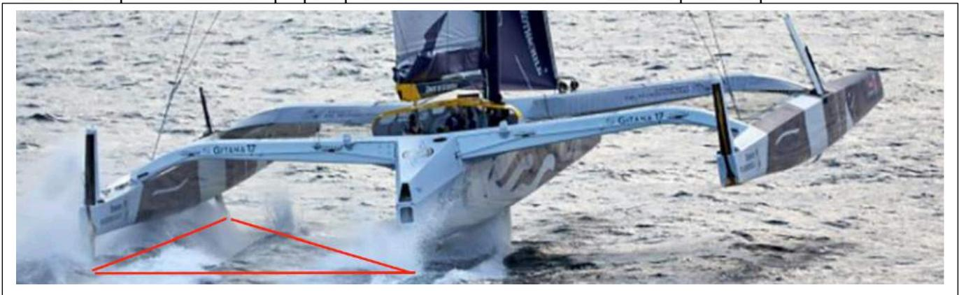
Pour qu'un solide soit automatiquement stable, il suffit de 3 points d'appuis.
