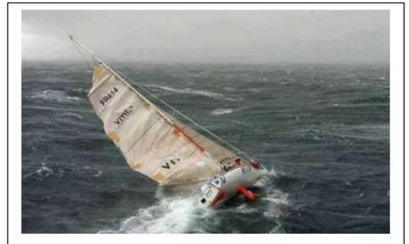
Comme le montre la photo ci-contre, avec environ 70° d'angle de gîte l'action du vent dans les voiles ne crée plus de couple de chavirage (les voiles faseillent). C'est encore plus vrai avec 90° de gîte.
