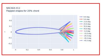
Un volet de bord de fuite mobile implanté sur le foil cambre son profil transversal et augmente la valeur de Cz. La portance croit alors avec l'angulation du volet de bord de fuite, jusqu'à une certaine limite fixée par l'apparition du phénomène de cavitation du profil. Lequel produit le décrochage du foil.
