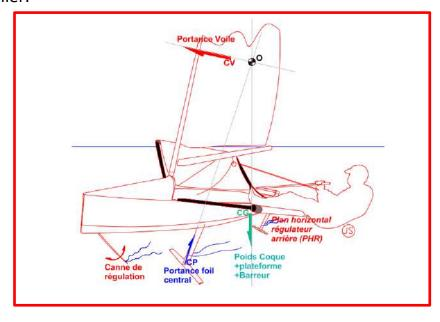
trajectoire aux variations de vitesse du vent réel (molle ou risée). Cela se traduit instantanément par un ralentissement ou une accélération du bateau. Par exemple, une chute effective de la vitesse instantanée du Moth de 14 à 13.5 nœuds provoquera une baisse de la portance de 7.02% (calcul sur le carré des variations de vitesse).
