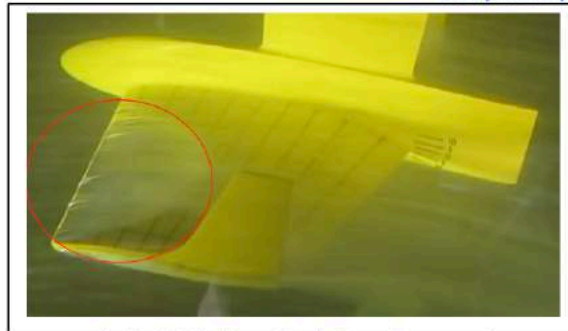
La surface recouvre près de 40%, la dépression de l'extrados est pratiquement réduite à zéro
